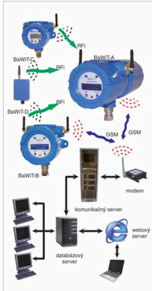
Obr. 1. SCT-Telemetry – schéma zberu údajov a komunikácie v systéme
