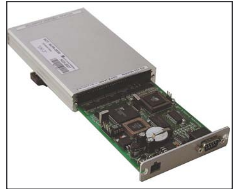
Obr. 3 Monitorovací počítač RTU - SCT3030 (UKI-3)
