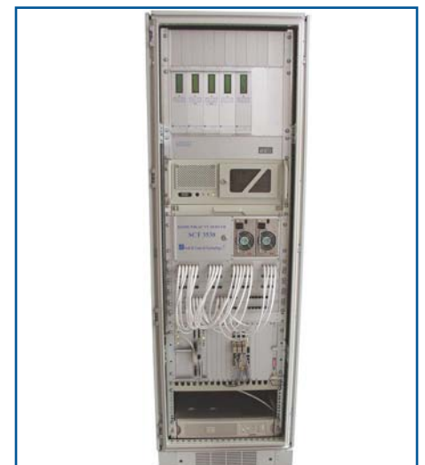
Obr. 2 Komunikačný server SCT (zostava SCT3530 aj so systémom FEP)
